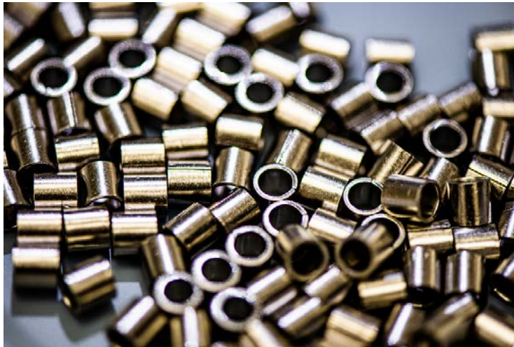
Figura 2.22. Diferentes tipos de relleno: Anillos Raschig de materiales metálicos (izquierda), licencia Pixabay y plásticos (derecha), fotografía de Andrea Starr | Pacific Northwest National Laboratory, publicada en Flickr, licencia CC BY-NC-SA
