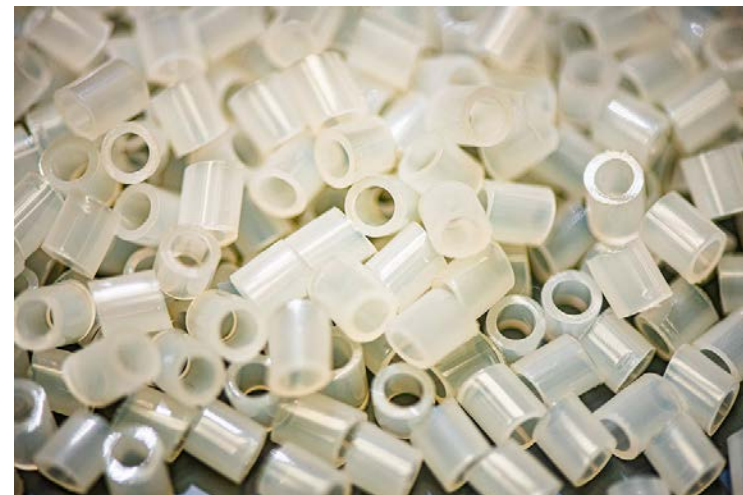
Figura 2.22. Diferentes tipos de relleno: Anillos Raschig de materiales metálicos (izquierda), licencia Pixabay y plásticos (derecha), fotografía de Andrea Starr | Pacific Northwest National Laboratory, publicada en Flickr, licencia CC BY-NC-SA
