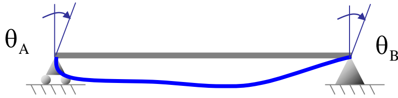
Deformada de la viga real
