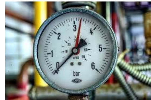
3.1 irudia. Gasen presioa neurtzeko manometroa. Pixabay-en CC0 lizentziapean argitaratutako argazkia [1]
