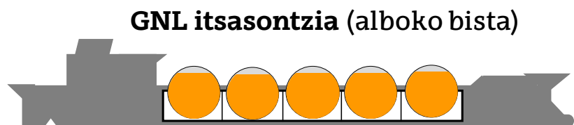
3.6 irudia. Zisterna esferikoko metano-itsasontzi baten alboko bista. Egileen irudia
