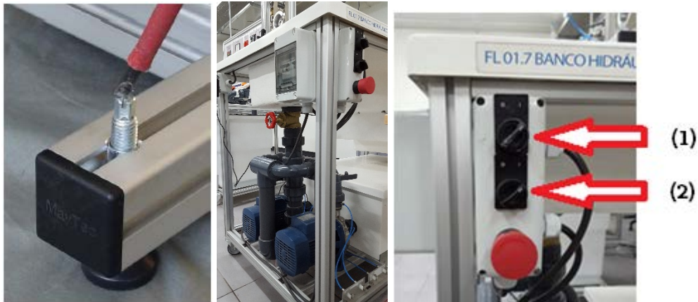
2. irudia. Turbina nibelatzeko sistema eta ponpen eragingailuak.
