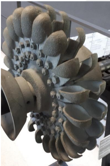
13.4 Irudia. Pelton turbina baten errodetea. Geure irudia.
