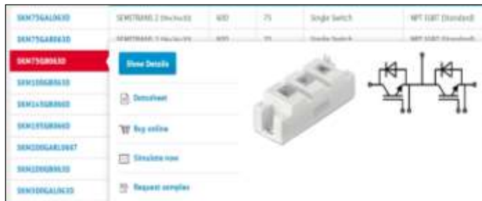
SEMIKRON SKM75GB063D 3 IGBT modulu berreskurapen diodoekin
