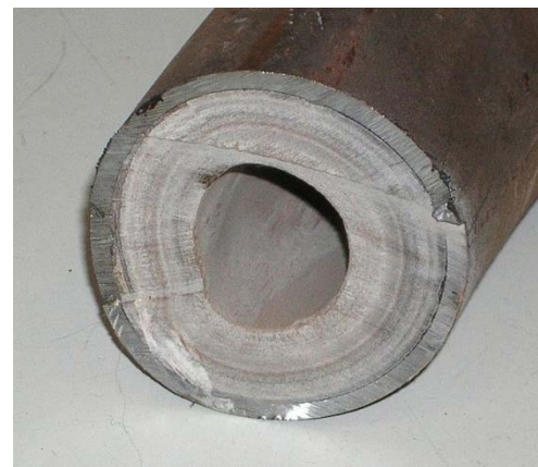
4.16. Irudia. Inkrustazioak dituen hodiaren zeharkako ebakidura. Wikimedian argitaraturiko irudia domeinu publikoetan [12] 23
