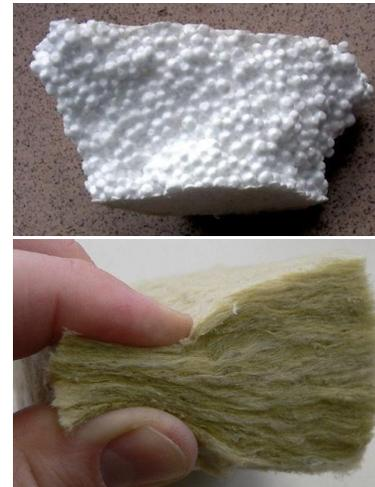
A elevada temperatura, por ejemplo para fabricar el aislamiento térmico de los hornos, se emplean materiales similares a la lana de roca, pero empleando fibras capaces de aguantar la temperatura que se requiera → Para temperaturas de 600°C ó 800°C se emplean fibras de sílice amorfa. Pero si la temperatura es muy elevada (por ejemplo 1400°C) se requieren fibras cerámicas de alúmina, o de otras cerámicas de elevado punto de fusión.
