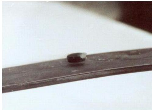
Figura 8.31: El efecto Meissner: las líneas de flujo magnético no penetran en el superconductor (izda). Superconductor flotando sobre un imán (dcha.). (Autoría, ver últimas páginas)
