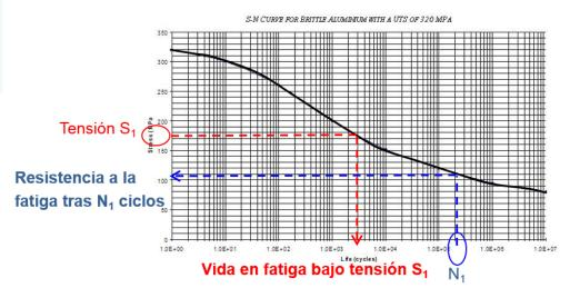
Figura 7.31: Curvas S-N de un acero y una aleación de aluminio (arriba). Vida en fatiga y resistencia a fatiga (abajo) (Autoría, ver últimas páginas)
