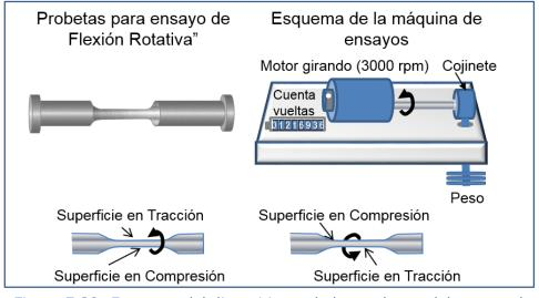
Figura 7.30: Esquema del dispositivo y de las probetas del ensayo de flexión rotativa.(Autoría, ver últimas páginas)
