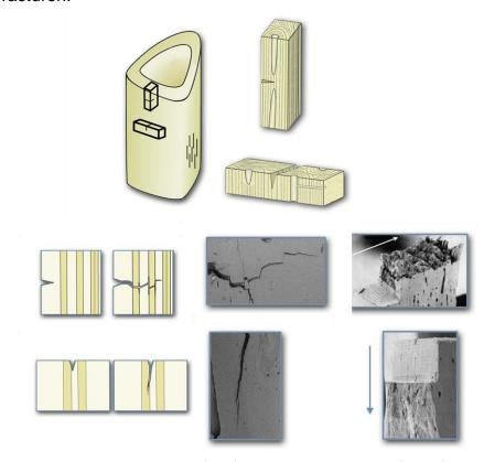
Figura 7.22: Fracturas producidas en ensayos SENB de probetas extraídas de hueso humano en dirección transversal y en dirección longitudinal. (Autoría, ver últimas páginas)
