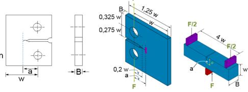
Figura 7.16: Probetas CT (izda. Y centro) y SENB (dcha.) para determiner la tenacidad a la fractura (Autoría, ver últimas páginas)
