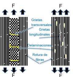
En resumen, los mecanismos de fractura en composites de fibras largas alineadas incluyen las delaminaciones y las fracturas de fibras a distinta altura, lo que conduce a que el frente de grieta se bifurque y se formen varias microgrietas que avanzan en direcciones diferentes. Esto ralentiza y dificulta el avance de la grieta.
