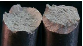
Figura 7.6: Probetas de Aleación de Aluminio AA2014 ensayadas en condiciones de impacto, mostrando la fractura frágil. (Autoría, ver últimas páginas)
