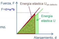
La diferencia de alargamiento es función del tamaño y forma de la grieta. Su cálculo no es sencillo (puede verse en *Fundamentals of Fracture Mechanics de* J.F. KNOTT, Editorial Butterworths, London 1973).
