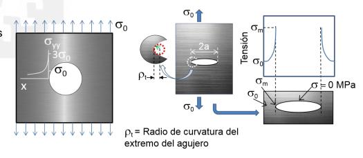
Figura 7.9: Defecto interno circular (izda.). Defecto interno elíptico (dcha.). (Autoría, ver últimas páginas)
