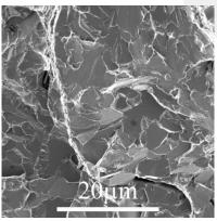
Figura 7.7: Fractura frágil intergranular (izda.) y fractura frágil transgranular (dcha.) tipo "clivaje". (Autoría, ver últimas páginas)
