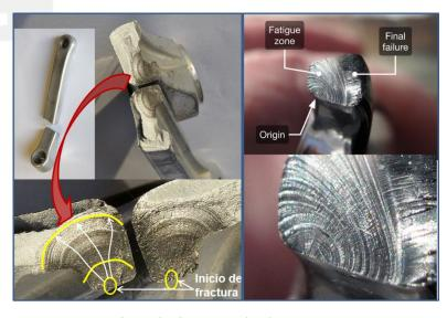
Figura 7.29: Superficie de fractura de dos componentes rotos por fatiga.(Autoría, ver últimas páginas)
