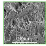
Figura 7.5: Probeta mostrando una fractura dúctil típica. Micrografías de dos zonas de una fractura dúctil. (Autoría, ver últimas páginas)
