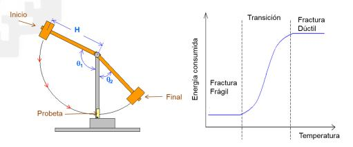
Figura 7.26: Ensayo de impacto para determinar la transición dúctil-frágil (izda.). Gráfico típico para determinar la transición dúctil-frágil de los materiales. (Autoría, ver últimas páginas)
