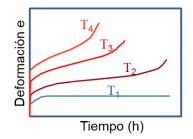
Figura 7.39: Proceso de fluencia bajo distinto nivel de tension (izda.) y bajo distinta T (dcha.). (Autoría, ver últimas páginas)
