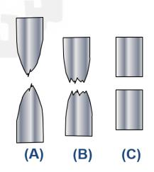
Figura 7.3: Fracturas macroscópicamente dúctiles (A y B) y frágil (C). (Autoría, ver últimas páginas)
