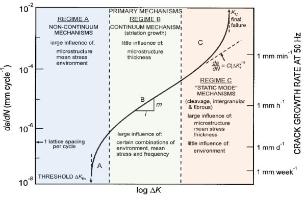
Figura 7.34: Crecimiento de grieta por fatiga. Gráfico que se obtiene de los ensayos de fatiga. (Autoría, ver últimas páginas)
