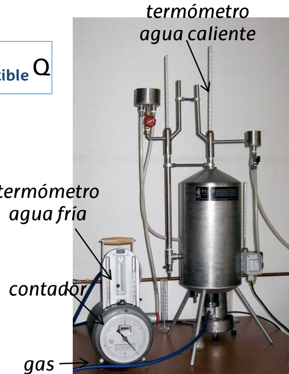
Figura 3.2. Calorímetro Junkers. Fotografía publicada en Wikimedia bajo licencia BY-SA 3.0 [2]
