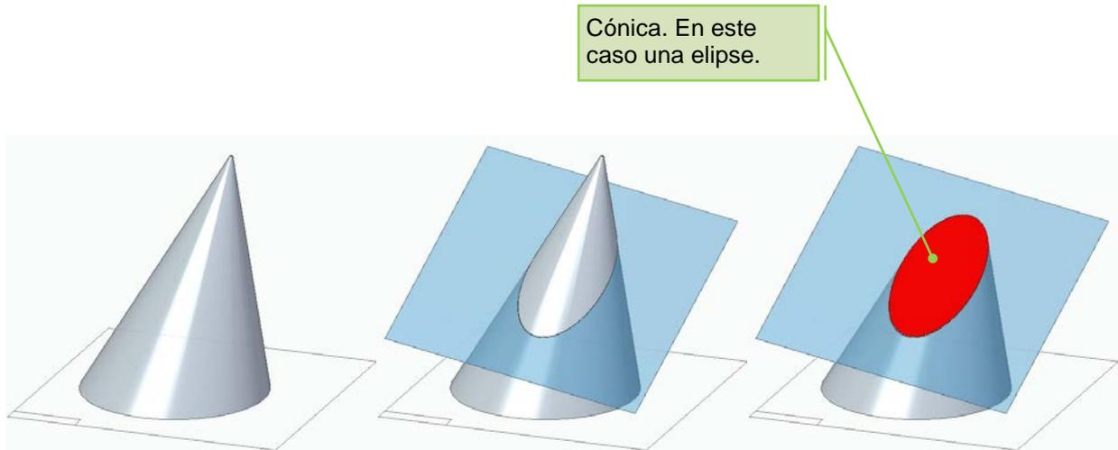
Figura 3.4. Sección plana de un cono (Imagen realizada con Solid Edge)
