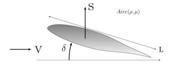
Se ensayan las propiedades aerodinámicas de un ala para un avión con un modelo a escala geométrica 1:16, una relación de pesos 1:16 y un ángulo de ataque de 16° en un laboratorio situado a nivel del mar.
