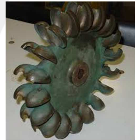
Fig. 13.4 Rodete de una turbina Pelton
