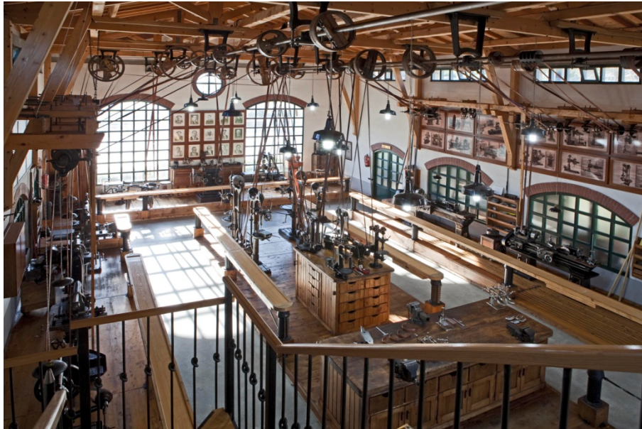
Figura 3. Vista general del taller del Museo de Máquina Herramienta con correas planas para repartir la potencia. Cortesía del Museo de Máquina Herramienta, Elgoibar.
