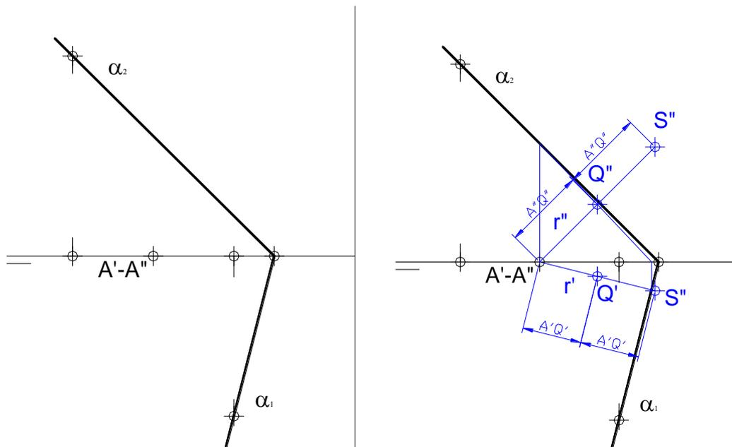
*Solución:* por  $A$  se traza la recta  $r$  perpendicular al plano  $\alpha$ ; se determina (mediante un plano auxiliar) la intersección de  $r$  y  $\alpha$ : el punto  $Q$ ; se lleva a la recta  $r$  (a partir del punto  $Q$ ) la distancia  $AQ$ , y se obtiene el simétrico de  $A$ : el punto  $S$ .
