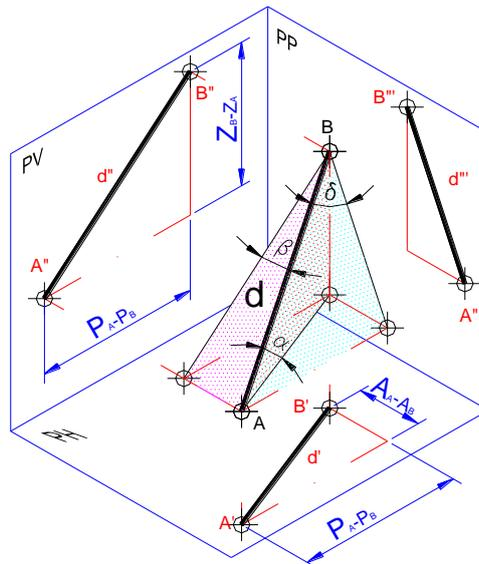
Otro de los resultados que se obtiene con la construcción de estos triángulos es el ángulo que forma el segmento con los planos de proyección PH, PV y PP en cada caso. Con  $d'$  el ángulo que forman con PH. Con  $d''$  el ángulo con PV y con  $d'''$  el ángulo con PP.
