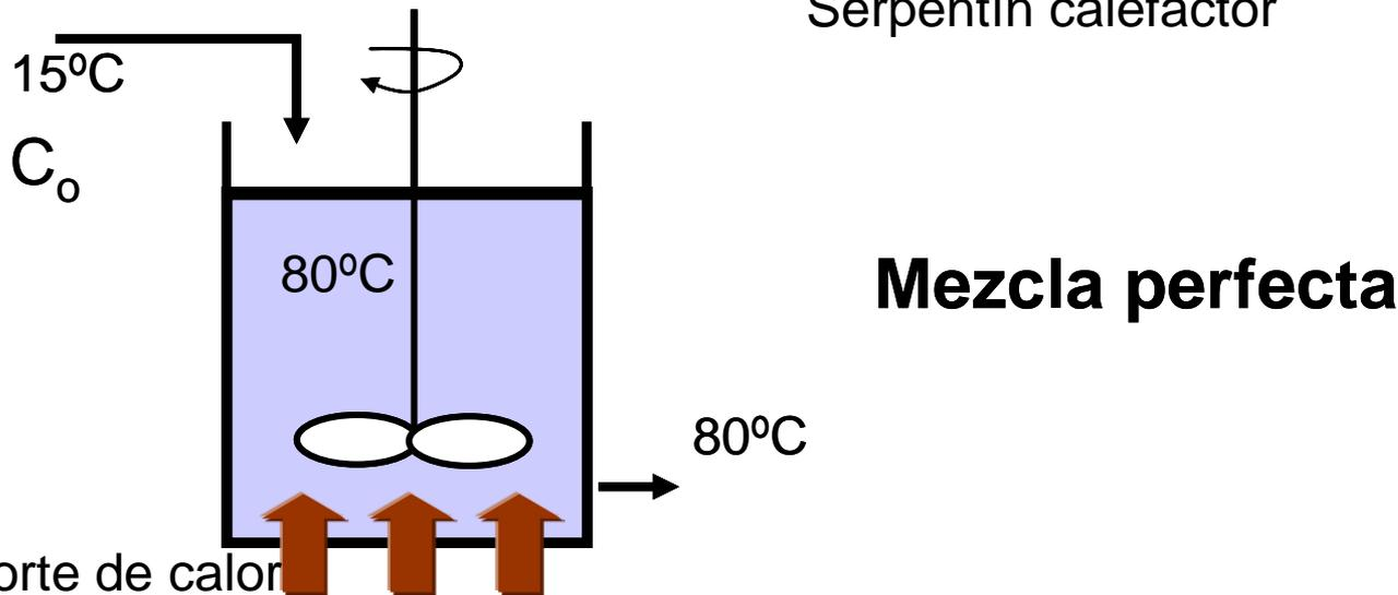
Distintos tipos de flujo, sin embargo, misma temperatura salida.
