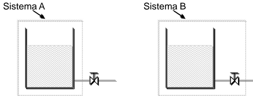
En un **sistema cerrado** la frontera impide el paso de cualquier **flujo de materia** a su través. En los **sistemas abiertos** la energía y/o materia pueden fluir hacia/desde el sistema.
