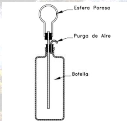
**Figura 3.4.** Atmómetro de esfera porosa tipo Livingstone
