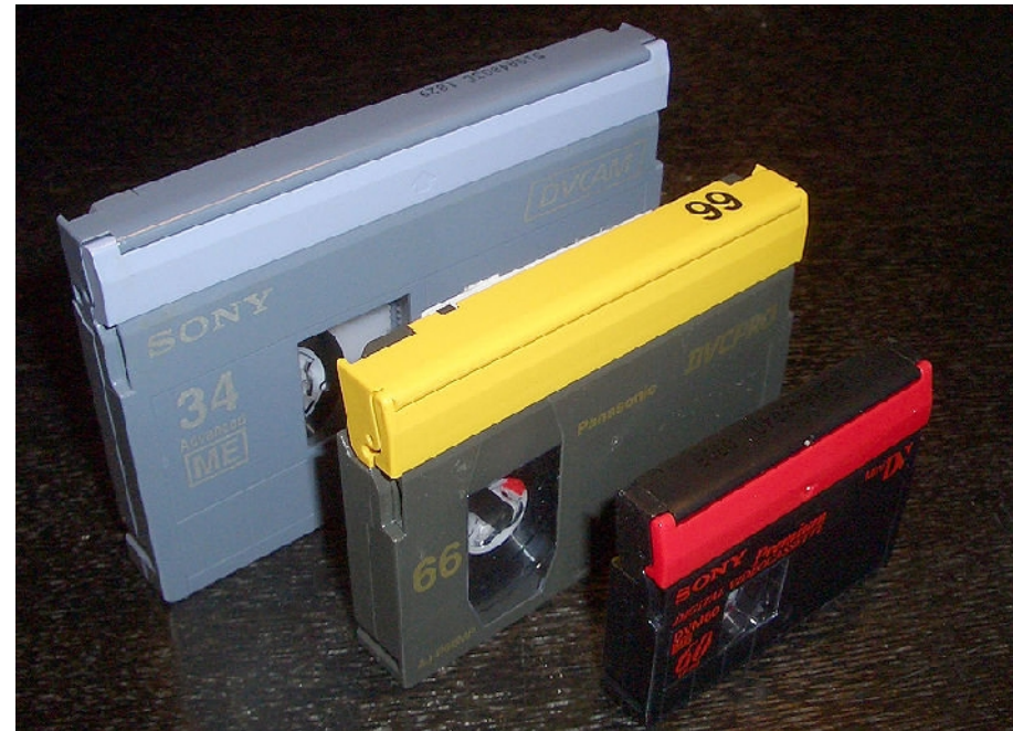
A DVCAM L tape, a DVCPRO M tape and a MiniDV tape. Imagen de grm_wnr, publicada en Wikimedia Commons
