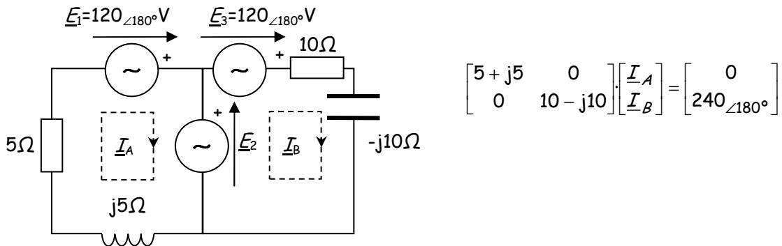
$$\begin{bmatrix} 5 + j5 & 0 \\ 0 & 10 - j10 \end{bmatrix} \begin{bmatrix} \underline{I}_A \\ \underline{I}_B \end{bmatrix} = \begin{bmatrix} 0 \\ 240 \angle 180^\circ \end{bmatrix}$$
