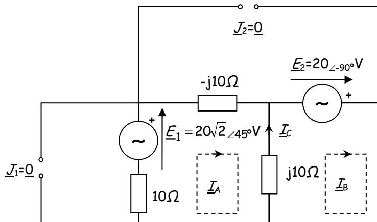
$$\begin{bmatrix} 10 & -j10 \\ -j10 & j10 \end{bmatrix} \begin{bmatrix} I_A \\ I_B \end{bmatrix} = \begin{bmatrix} 20 + j20 \\ -j20 \end{bmatrix}$$
