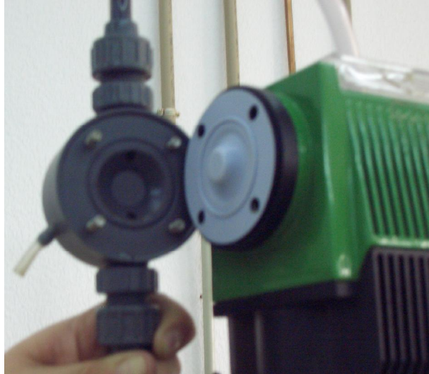
Figura 12.3. Imagen de una bomba de membrana (la membrana es la pieza blanca).
