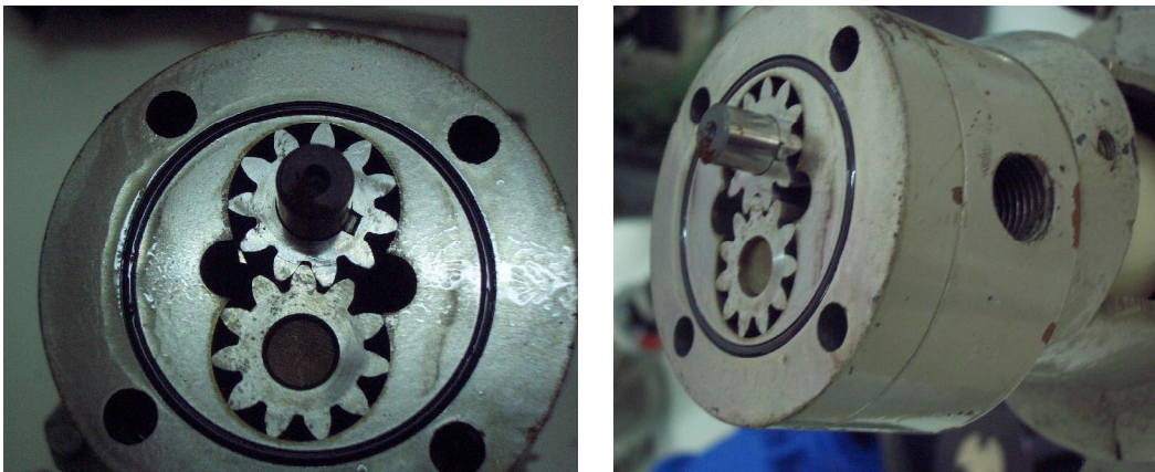
Figura 12.5. Vista frontal y lateral de una bomba de engranaje abierta.
