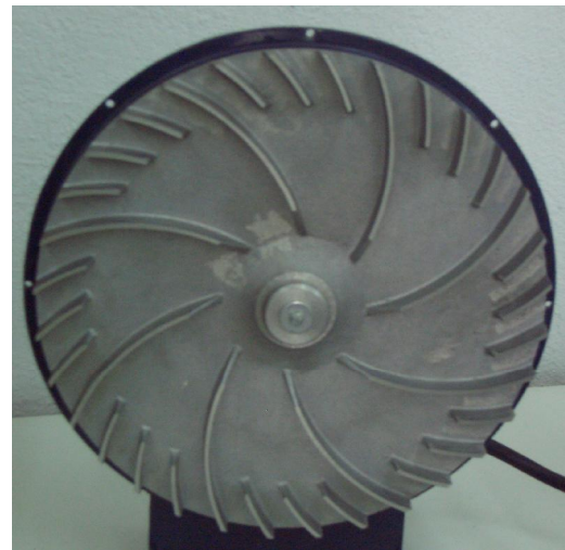
Figura 1.4. Trayectoria descrita por un elemento de fluido a su paso por el rodete de una turbomáquina radial. A la derecha se muestra una turbomáquina radial, donde se puede apreciar el aspecto del rodete.
