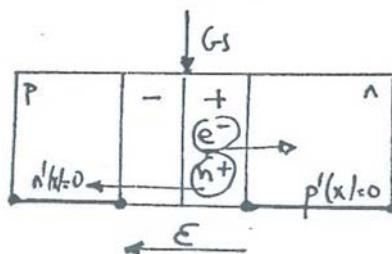
e)  $J = J_{iluminación} + J_{polarización} = J_{sat} \cdot \exp(V/V_T - 1) - q \cdot m_L$
