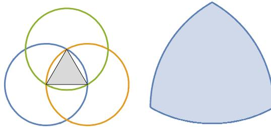
Imagen 5. Generación de un triángulo Reuleaux (imagen propia)
