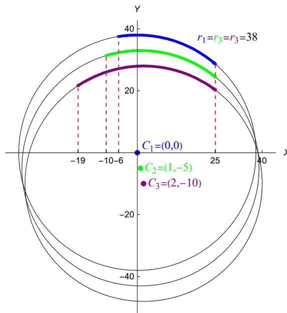
Imagen 5. Planta de las secciones esféricas (imagen propia)
