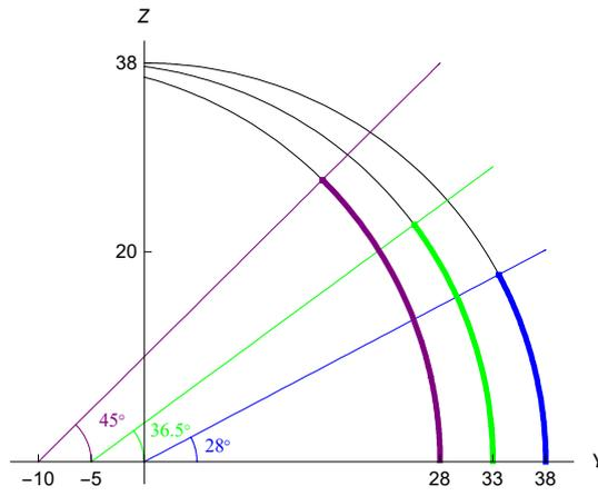
Imagen 6. Alzado de las secciones esféricas (imagen propia)
