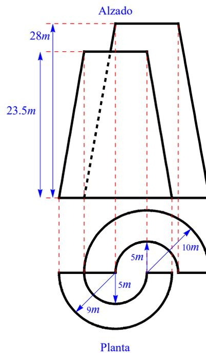
Imagen 3. Alzado y planta de las superficies cónicas (imagen propia)
