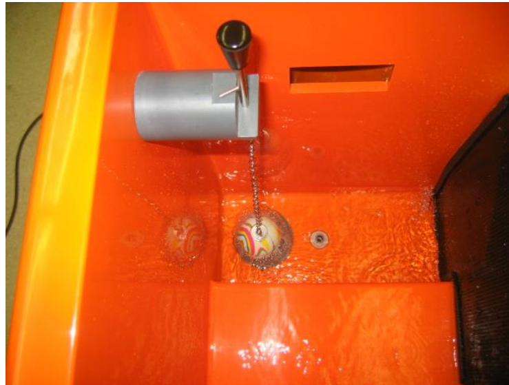
Figura 1: Bola de cierre del desagüe del banco hidráulico.
