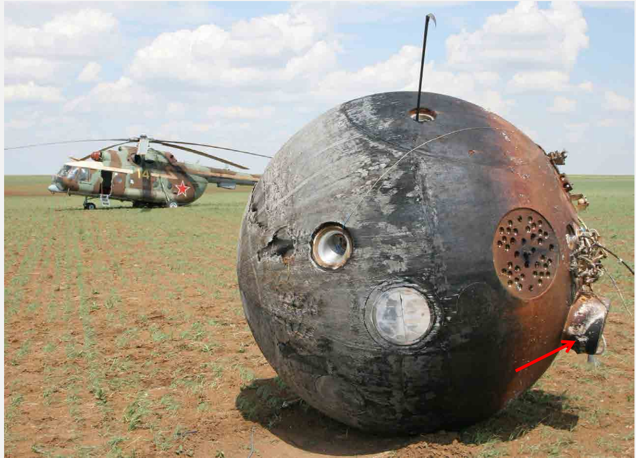
Lugar de aterrizaje de la cápsula Foton que muestra el desgaste de su estructura al atravesar la atmósfera terrestre. La flecha indica la ubicación del biopan Imagen cedida amablemente por: Leopoldo García Sancho
