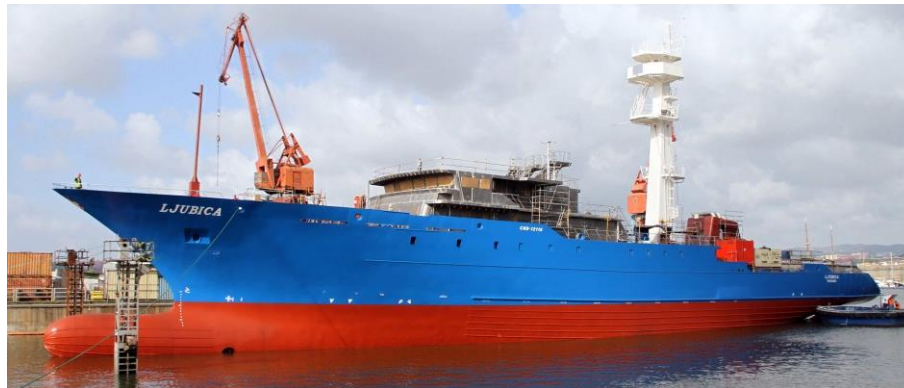
Figura 12. (a) Atunero “Ljubica” construido por Zamakona (2014) dispone de apéndices a lo largo del casco para dirigir el agua a la zona de la hélice y (b) barco de apoyo “Esvag Albert Betz” en construcción con proa diseñada para gran oleaje (2019) [1]
