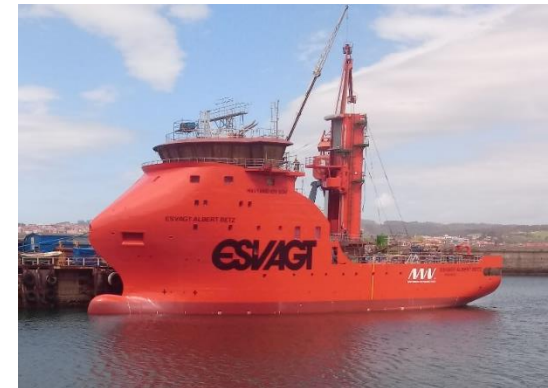
Figura 12. (a) Atunero “Ljubica” construido por Zamakona (2014) dispone de apéndices a lo largo del casco para dirigir el agua a la zona de la hélice y (b) barco de apoyo “Esvag Albert Betz” en construcción con proa diseñada para gran oleaje (2019) [1]
