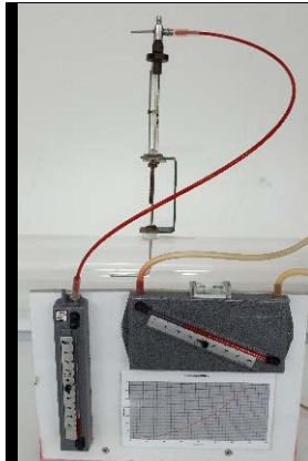
3. irudia. Presio estatikoa neurtzeko hartunea lehenengo Prandtl tutuaren bidez (1 neurgailua), eta presio dinamikoa bigarren Prandtl tutuaren bidez (2 neurgailua).
