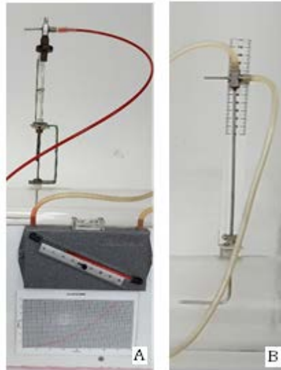
1. irudia. Prandtl tutua, presio estatikoa eta dinamikoa.
