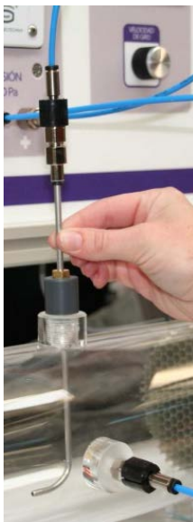
5. irudia. Xurgapen-hodian kokatutako Pitot-a, korrante-lerroen paralelo.
