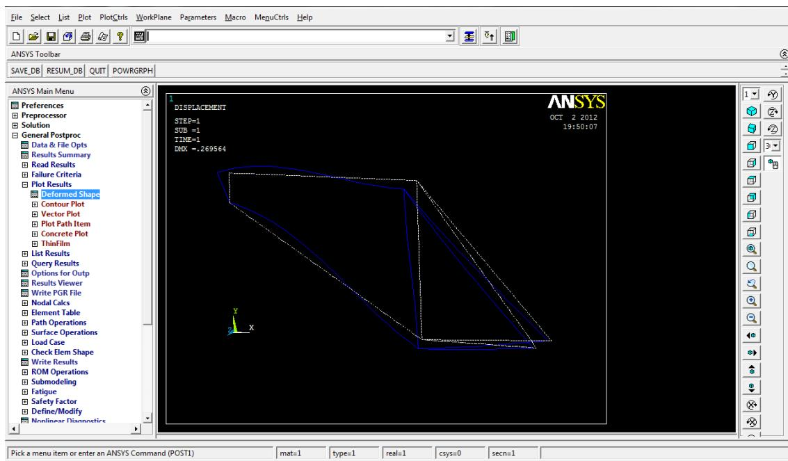
> Element Table > Define Table > Add: Definir tabla de resultados (SMISC6 y SMISC12, momentos en el eje Z para el elemento pipe16 en los nodos i y j de cada elemento)
