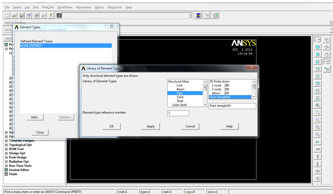
> Real Constants > Add/Edit/Delete > Add: introducir las propiedades de la sección del elemento tubo (diámetro exterior 25 mm, espesor 2 mm)
