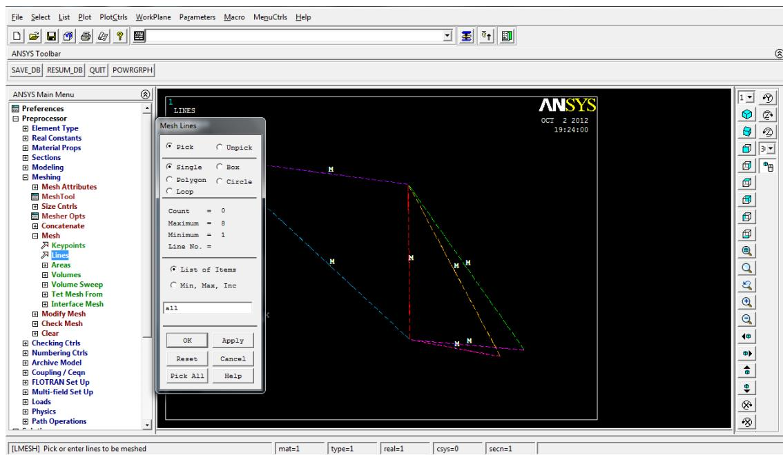
> Loads > Define Loads > Apply > Structural > Displacement > On Keypoints: introducir condiciones de ligadura en el keypoint seleccionado (UX, UY, UZ restringidos a 0 en el keypoint 1; UY, UZ restringidos a 0 en los keypoint 5, 6)
