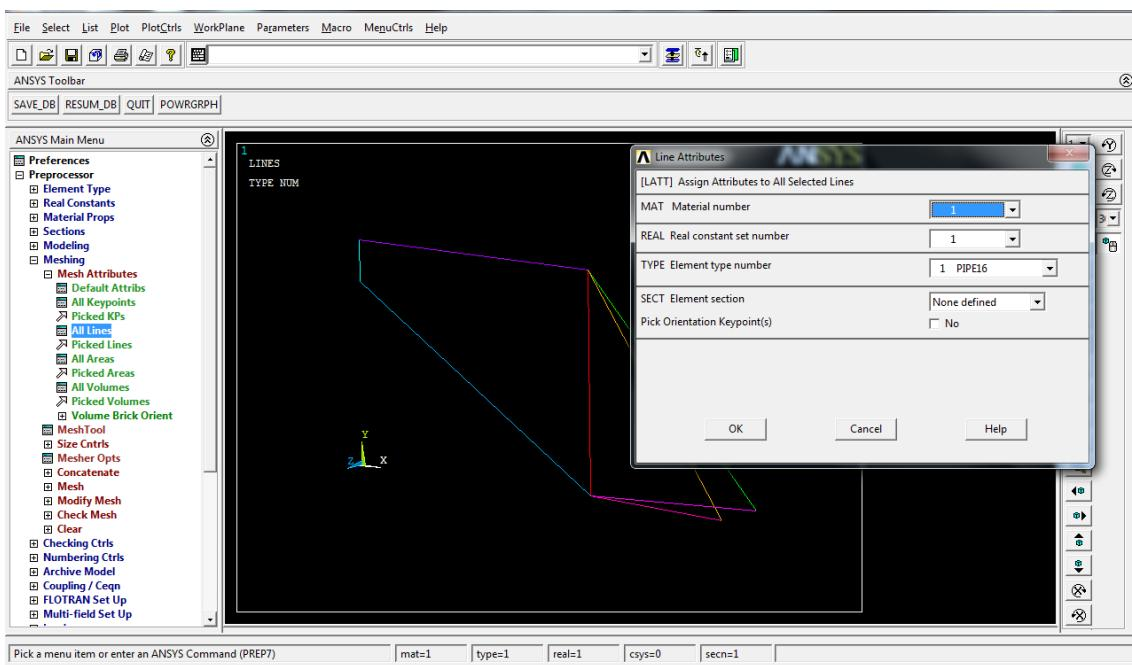
> Meshing > Size controls > ManualSize > Lines > All Lines: especificar tamaño de los elementos de la malla (elementos de longitud 20)
