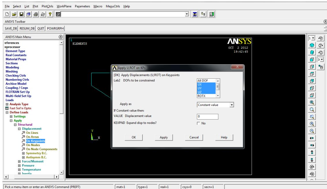
> Loads > Define Loads > Apply > Structural > Force/Moment > On Keypoints: introducir una fuerza o momento en el keypoint seleccionado (fuerza Fy=-600 en el keypoint 3 y fuerza Fy=-200 en el keypoint 4)
