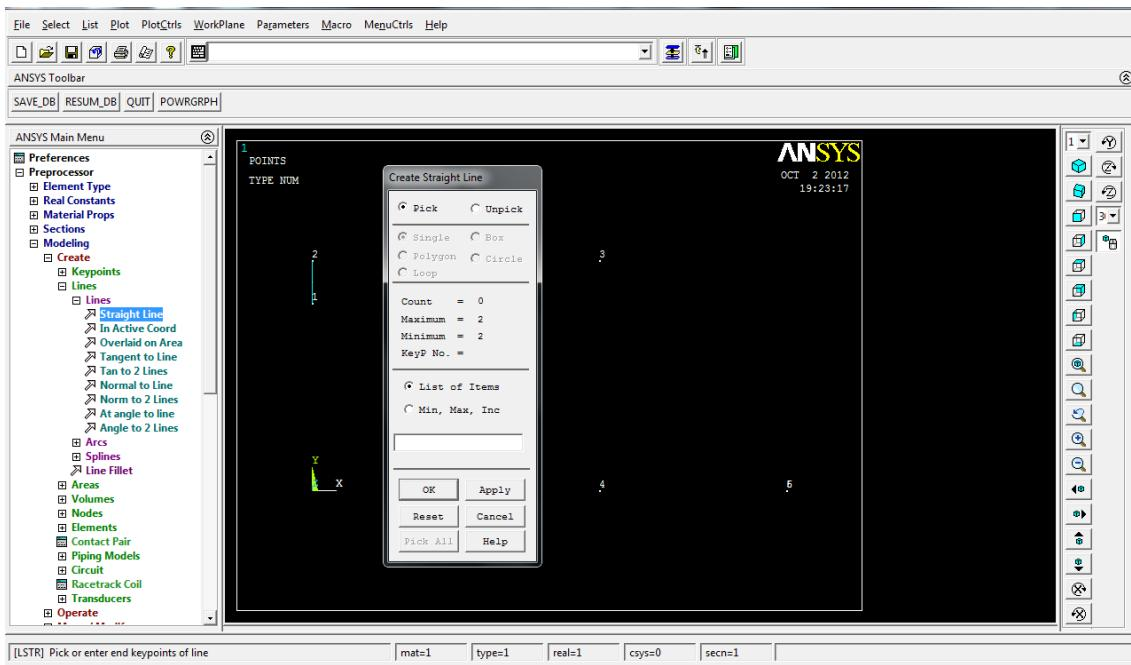
> Meshing > Mesh attributes > All lines: especificar las características de la malla de la línea (material 1, elemento tipo pipe16, real constant 1)
