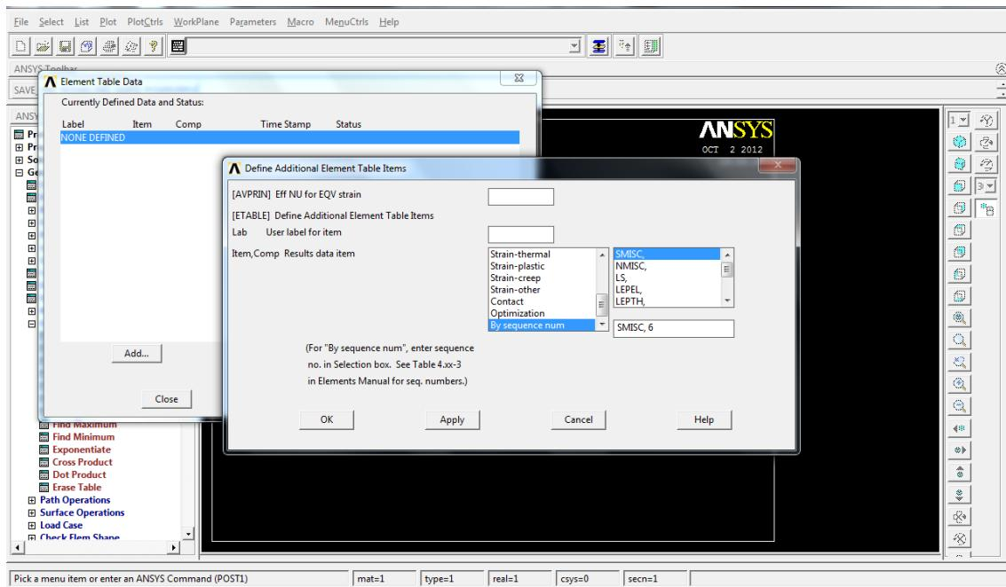
> Plot Results > Contour Plot > Line Elec Res: dibujar tabla de resultados (SMISC6 y SMISC12, momentos en el eje Z para el elemento pipe16 en los nodos i y j de cada elemento)
