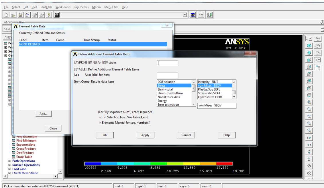
> Plot Results > Contour Plot > Elem Table: dibujar tabla de resultados (SEQV, tensión equivalente de Von Mises)
