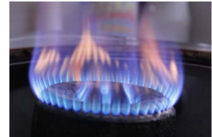
Figura 3.3. Puntas amarillas en quemador de gas natural. Fotografía publicada en pxhere bajo licencia CC0 [5]
