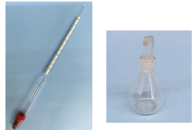
Figura 2.5. Densímetro y picnómetro para la medida de densidad de combustibles líquidos. Imágenes propias
