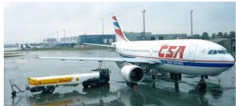
Figura 2.12. Aeronave repostando keroseno. Fotografía de Kristoferb publicada en Wikimedia bajo licencia CC BY-SA 3.0 [12]
