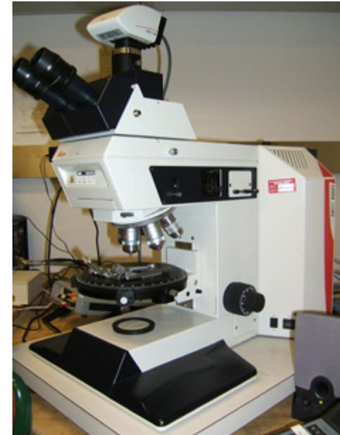
En la fig. 1.4 se presenta un microscopio petrográfico utilizado para realizar el análisis de macerales.
