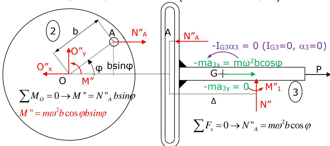
GAINJARPENA:  $M = P b \sin \varphi + m \omega^2 b^2 \cos \varphi \sin \varphi$
