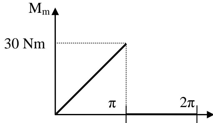
Ardatz honen momentu erresistente murriztua konstantea dela jakinik, ardatz nagusian montatu behar den inertzia-bolantearen inertzia-momentua kalkulatu, ardatz nagusiaren abiadura  $210 \pm 10$  bira minutuko izan dadin. Inertzia-bolantea A-42 altzairukoa ( $\sigma_y = 42 \text{ kg/mm}^2$ ) bada, zenbatekoa izango da bere bataz besteko erradio maximoa?
