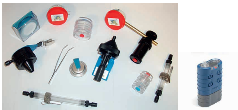
Figura 5.7. Equipos de medición con bomba de muestreo (derecha).
