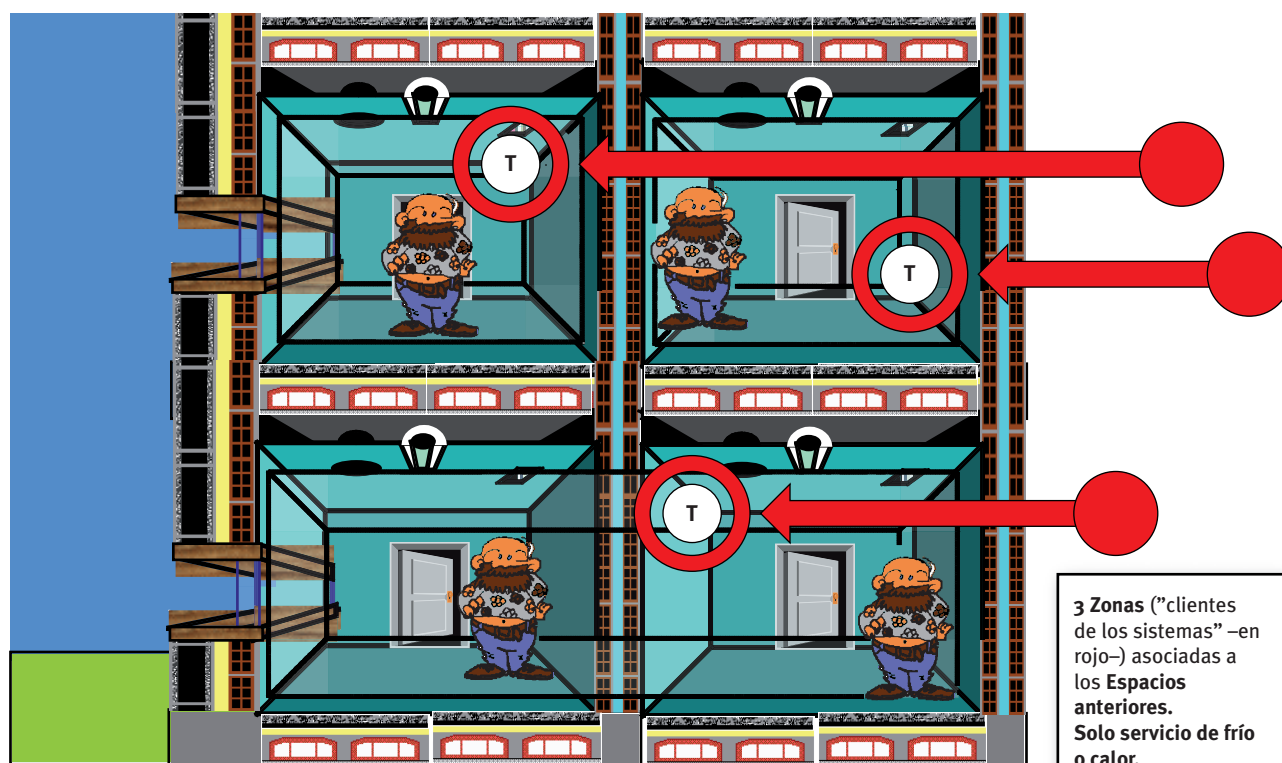
Espacios (geometría) con “física” asociada: muros, ventanas, ocupantes, luces, etc. = Recinto o Local
