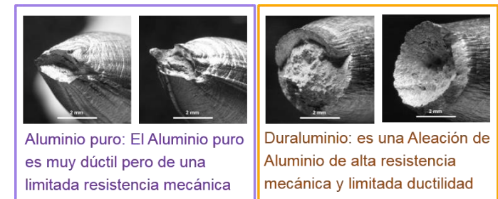
Figura 6.21: Comportamiento tensión-deformación de dos aleaciones de aluminio junto con las imágenes de las superficies de fractura de las probetas ensayadas. (Autoría, ver últimas páginas)
