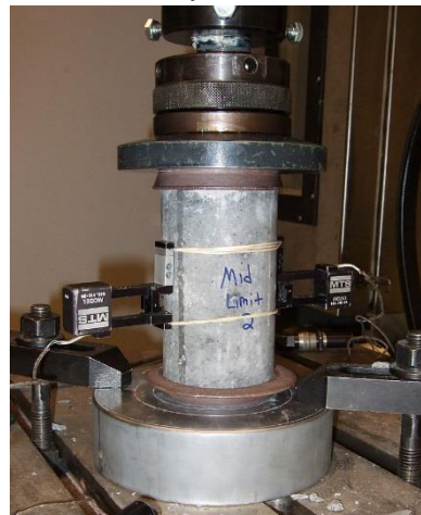
Figura 6.23: Ensayo de compresión de hormigón (Autoría, ver últimas páginas)
