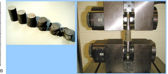
Figura 6.24: Ensayo de compresión de metales (Autoría, ver últimas páginas)
