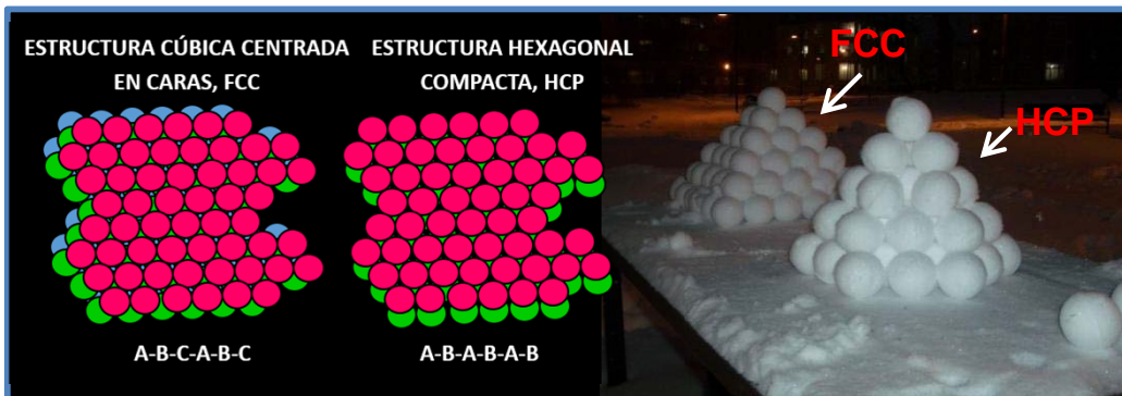
Figura 3.12: Esquema de apilamiento de planos compactos atómicos en las estructuras FCC y HCP. (Autoría, ver última página)
