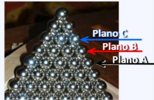
Figura 3.10: Esquema de la celdilla unidad y del apilamiento de planos atómicos en una estructura FCC (Autoría, ver última página)
