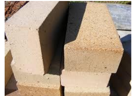
Figura 4.7. Ladrillos refractarios. Fotografía tomada por byrev y publicada en Pixabay bajo dominio público [6]
