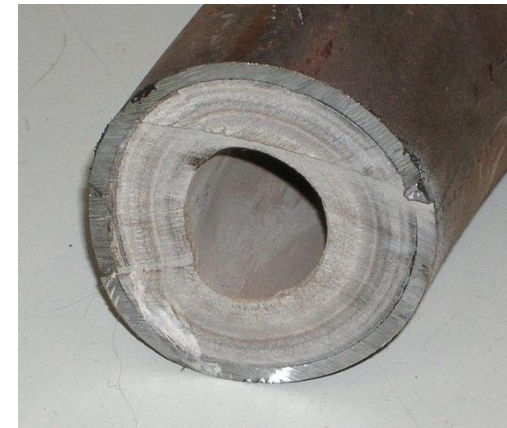
Figura 4.16. Sección transversal de un tubo con incrustación calcárea. Fotografía publicada en Wikimedia bajo dominio público [12]
