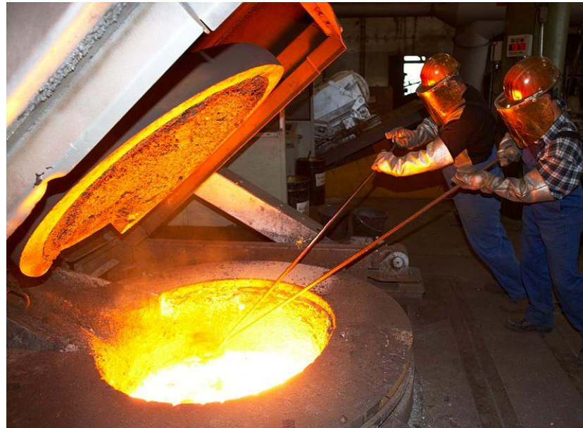
Figura 4.11. Horno de inducción en una fundición. Fotografía publicada en Wikimedia bajo dominio público [7]
