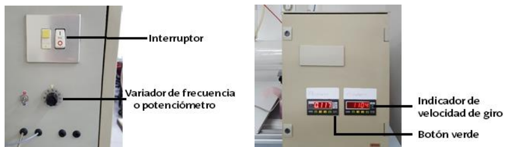
Figura 2: Interruptor del ventilador y variador de frecuencia o potenciómetro (izquierda). Panel de lectura de potencia y velocidad de giro (derecha).
