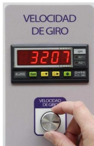
**Figura 3:** Variador de frecuencia del ventilador axial.
