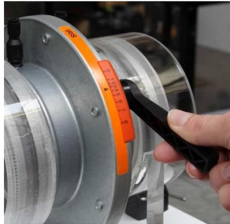
**Figura 4:** Maneta reguladora del caudal de impulsión.
