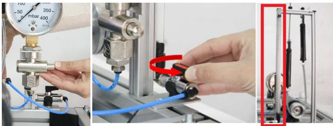
Figura 4: Modo de actuación para la toma de presión en el Manómetro Bourdon o columna de agua.
