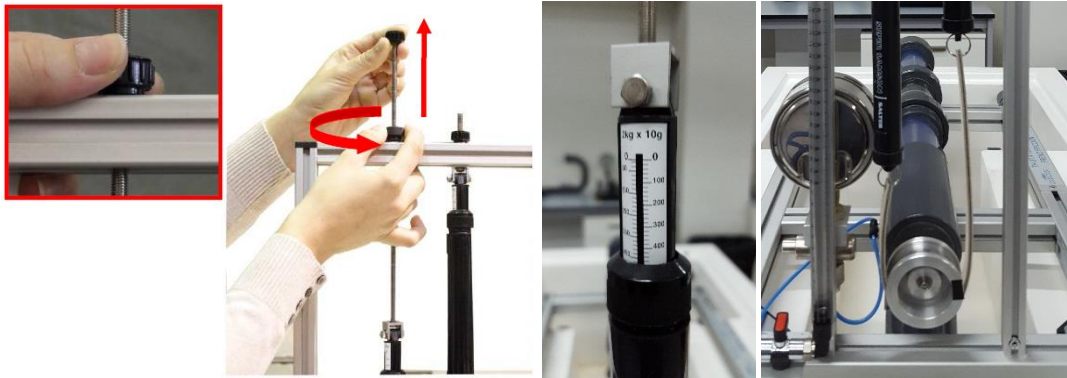
Figura 3: A: Dinamómetro y detalle de la tuerca moleteada. B: Detalle de la medida del dinamómetro. C: Freno de la turbina.
