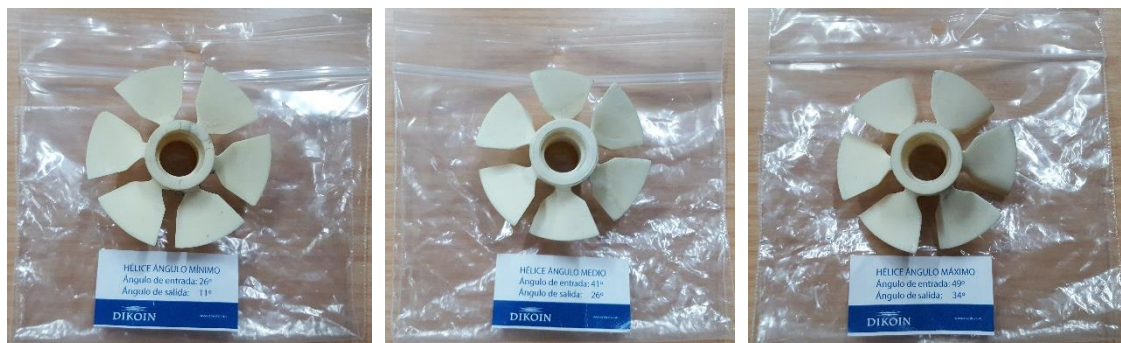
Figura 5: Diferentes tipos de rodetes disponibles para trabajar con la turbina Kaplan.
