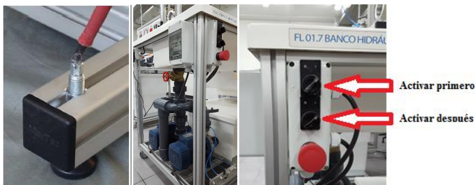
Figura 2: Sistema de nivelado e interruptores para el accionamiento de las bombas.
