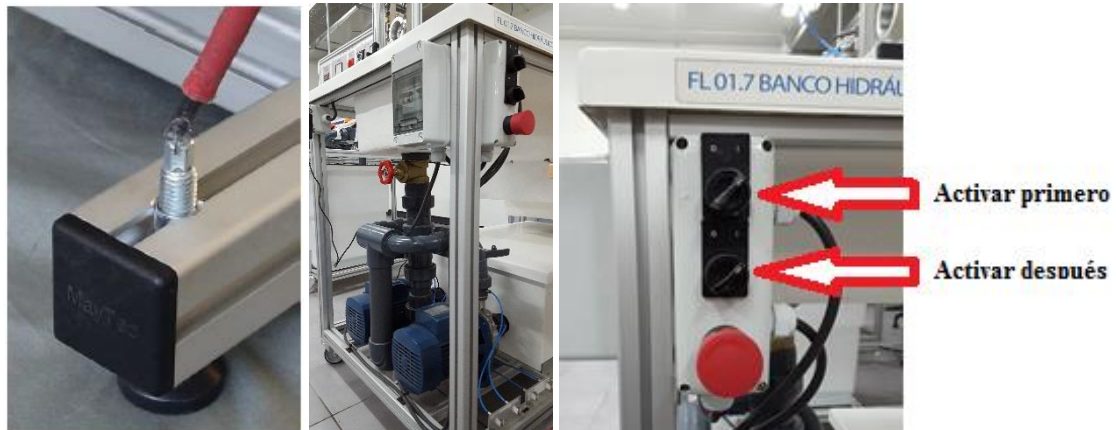
Figura 2: Sistema de nivelado de la turbina e interruptores para el accionamiento de las bombas.
