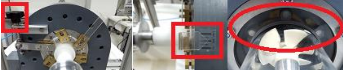
Figura 4: Modo de regulación de los álabes directrices de la turbina.
