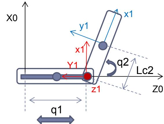
Termino de la energía cinética total del 2 eslabón:  $K_2 = \frac{1}{2}m_2 \left[ \dot{q}_1^2 + L_{c2}^2 \dot{q}_2^2 - 2\dot{q}_1 \dot{q}_2 L_{c2} S q_2 \right] + \frac{1}{2} I_2 \dot{q}_2^2$
