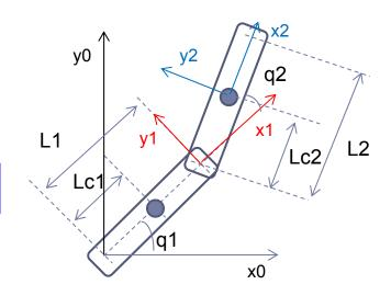
$$v_{2} = \begin{bmatrix} -L_{1}Sq1 - L_{c2}[S(q1+q2)] & -L_{c2}[S(q1+q2)] & 0 \\ L_{1}Cq1 - L_{c2}[C(q1+q2)] & L_{c2}[C(q1+q2)] & 0 \\ 0 & 0 & 0 \end{bmatrix} \begin{bmatrix} \dot{q}1 \\ \dot{q}2 \\ 0 \end{bmatrix} = \begin{bmatrix} (-L_{1}Sq1 - L_{c2}[S(q1+q2)])\dot{q}1 - L_{c2}[S(q1+q2)]\dot{q}2 \\ (L_{1}Cq1 - L_{c2}[C(q1+q2)])\dot{q}1 + L_{c2}[C(q1+q2)]\dot{q}2 \\ 0 \end{bmatrix} = v_{2}$$
