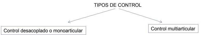
Se considera el modelo del robot compuesto por una superposición de articulaciones independientes, sin tener en cuenta la interacción entre ellas. En este caso el modelo dinámico empleado es el de un accionador (motor eléctrico). La desventaja principal es la influencia del movimiento de una articulación en las siguientes y en consecuencia en el movimiento global.
