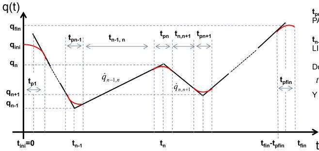
$t_{pn}$ = intervalo de tiempo del ajuste PARABOLICO en un  $q_n$
