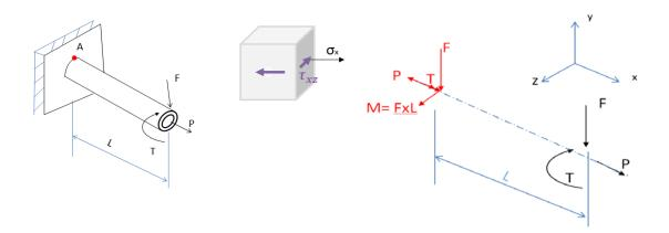
Una vez identificada la sección más crítica, se procederá al cálculo de las tensiones. Como al sistema se le aplica una fuerza axial P, una fuerza F que genera el momento flector M y un momento torsor T:
